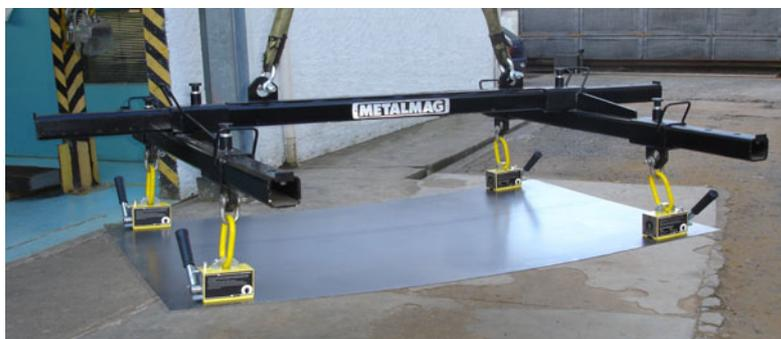
Para movimentação de chapas longas e/ou largas, a Metalmag produz pórticos reguláveis para 4 levantadores, para chapas de 1,0 m x 1,5 m até 2,5 m x 4,0 m, adaptáveis a qualquer modelo de Levantador Metalmag. Capacidade máxima de 4.000 kgf. Dimensões maiores sob consulta.
