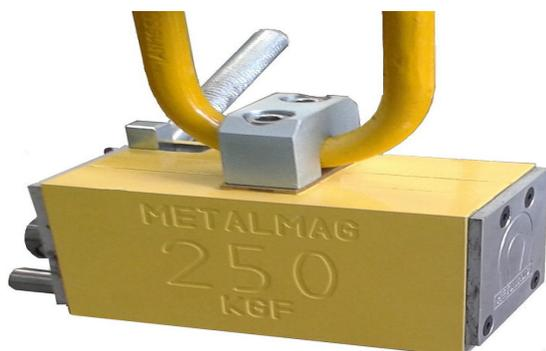
Capacidade de carga gravada no corpo do equipamento
